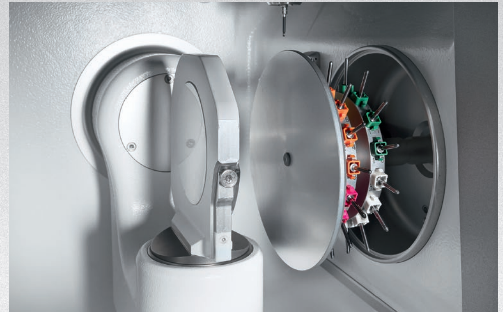
Stoccaggio con azione attiva antipolvere nella macchina grazie alla tecnica degli ambienti sterili
